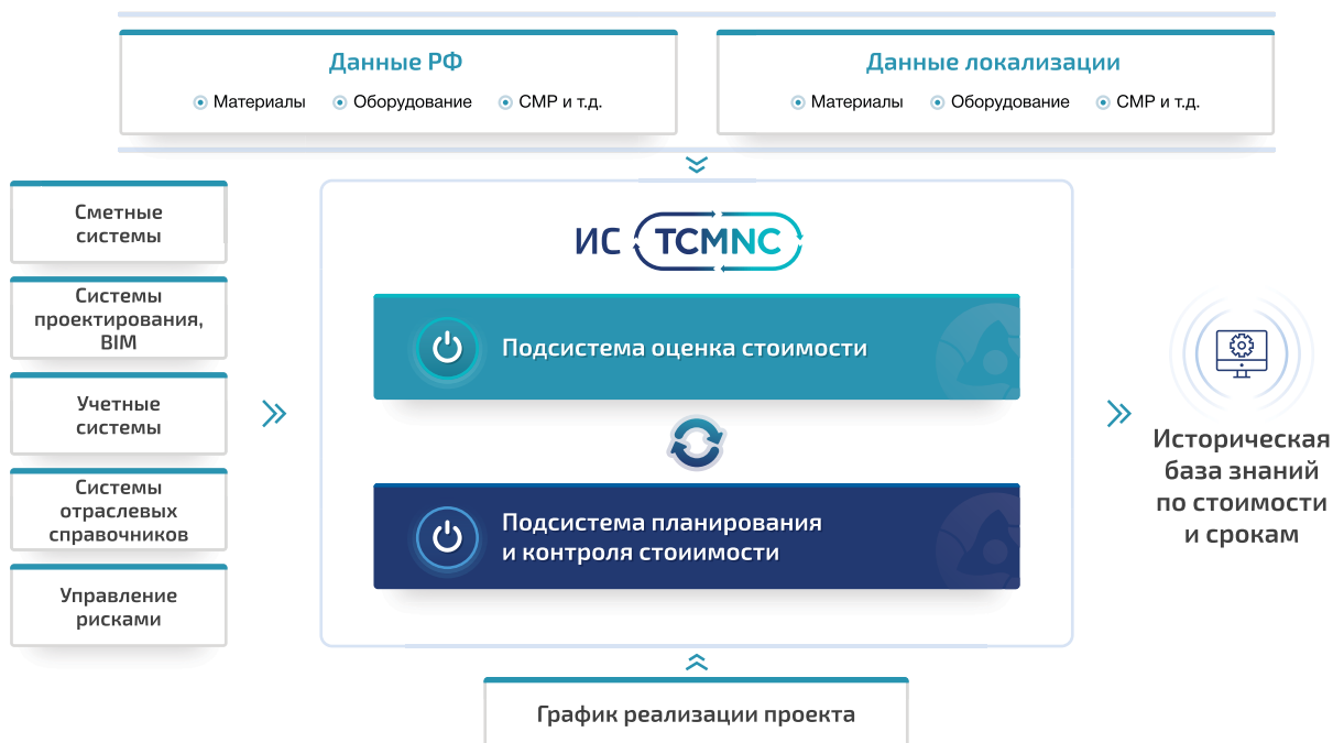
Рисунок 5.1.1. Архитектура информационной системы TCM NC
